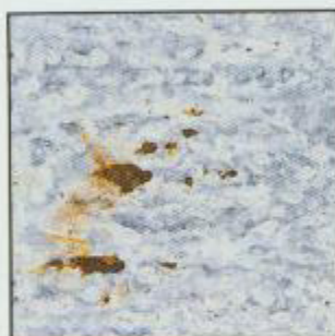
镀锌钢板于测试 500 小时后 Galvanized 500 Hours
