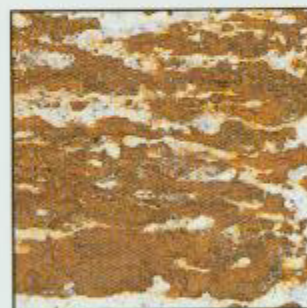
镀锌钢板于测试 2000 小时后 Galvanized 2000 Hours
